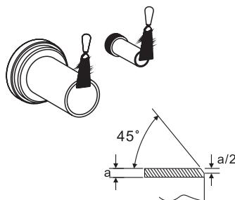
**A:** Skub indløbsrør og afløbsrør ind i væggens/indbygningscisternens muffer til de ikke kan komme længere og markér med en streg hvor vægniveauet er.
