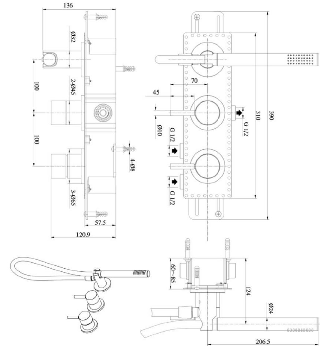
1. Armaturets indbygningsboks kan fastgøres i enten vingerne der er forrest på boksen eller øjerne der er bagerst på boksen. Kontrollér at sidder i lod og vase. Og kontrollér at den færdige dybde er overholdt. Det angivne dybdemål, markeret med MAX og MIN er til FORKANT af flisen.
